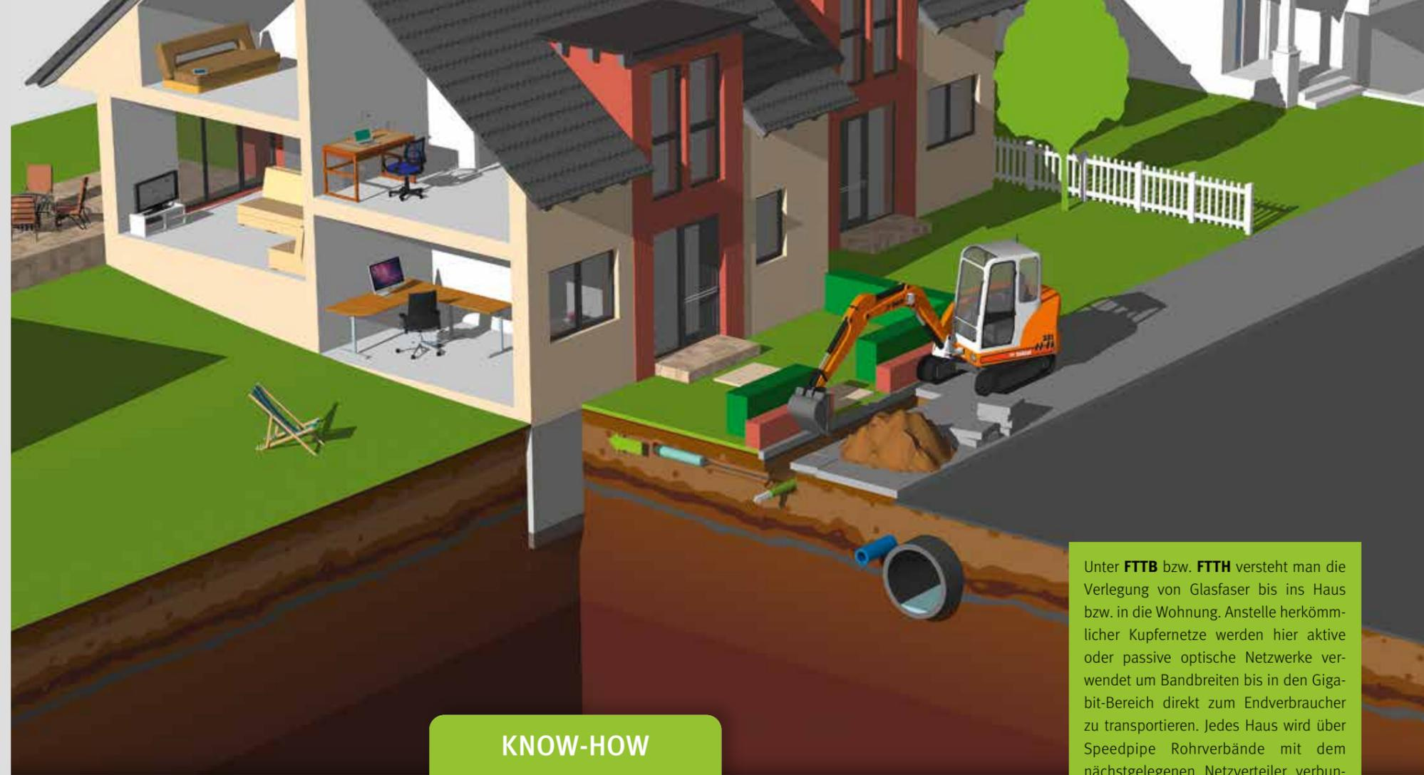
Unter **FTTB** bzw. **FTTH** versteht man die Verlegung von Glasfaser bis ins Haus bzw. in die Wohnung. Anstelle herkömmlicher Kupfernetze werden hier aktive oder passive optische Netzwerke verwendet um Bandbreiten bis in den Gigabit-Bereich direkt zum Endverbraucher zu transportieren. Jedes Haus wird über Speedpipe Rohrverbände mit dem nächstgelegenen Netzverteiler verbunden und von dort über optische Splitter oder dedizierte Fasern zum Aktivtechnikstandort.
